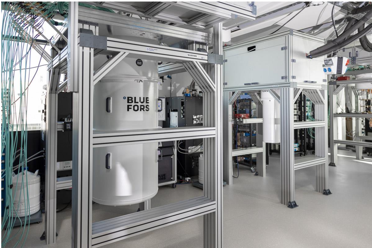
Kryostat, in dem die Zentraleinheit des QSolid-Prototyps gekühlt wird © Institute for Functional Quantum Systems / Forschungszentrum Jülich / Sascha Kreklau
